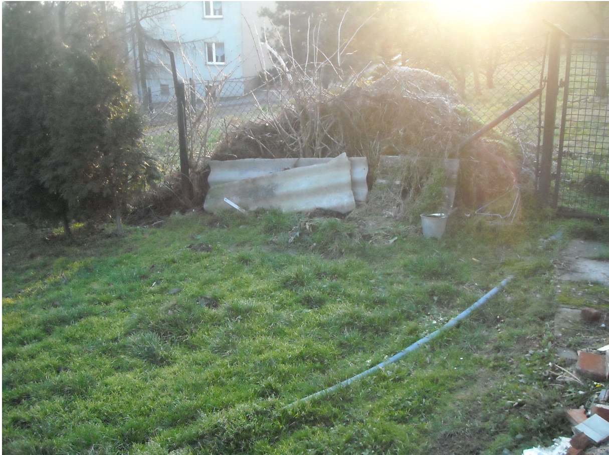
Rysunek 14 Płyty azbestowe składowane na posesji na terenie Pszowa
